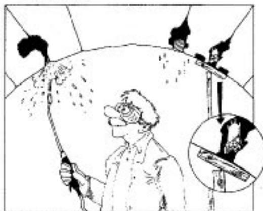
9. Les joints peuvent être refaits. Le bouchon posé initialement qui peut être enlevé lors de ces derniers travaux doit être solide pour ne pas disparaître pendant le nettoyage.
